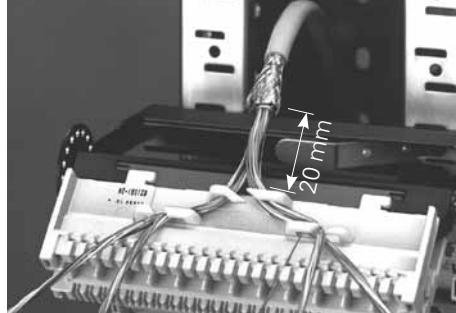
Kabel nach Farbcode (rechts beginnend) mit Beschaltungswerzeug VS (Artikel R 19001) aufschalten, wobei Kontakt [c] der Aufschaltung des Beilauf-drahtes dient.
