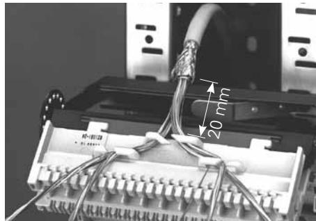
Disporre la striscia di connessione sulla consolle di cablaggio con il lato cavo rivolto verso l'alto. Posizionare l'estremità della schermatura del cavo circa 20 mm dietro il bordo della striscia.
